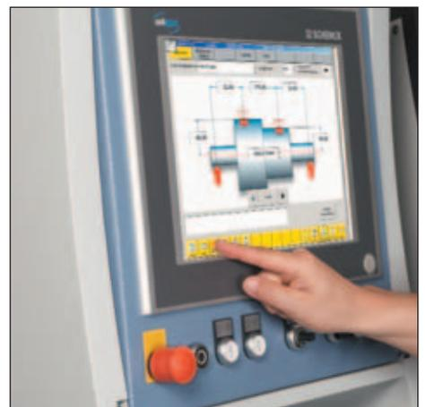
Die 5. Generation digitaler Auswucht-Mess-technik von Schenck: CAB 920 – es bietet Ihnen perfekt ausgewuchtete Rotoren, und das bei einfachster Bedienung.
